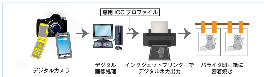
図. デジタルと銀塩とを組み合わせた DGSM Print の大まかなワークフロー
