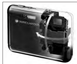
4) レンズユニットスイング方式 レンズユニットと画像センサーを一体で動かす。
