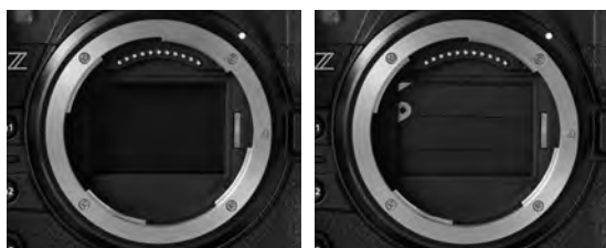
センサーシールド機能によりゴミの付着の軽減ができる
