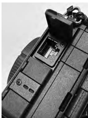
LAN端子が付いたデジタル一眼カメラ。キヤノンはEOS-1D Xから、ニコンはD4から(いずれも2012年発売)、遅れて参入したソニーもα1(2021年発売)からハイエンド機では当たり前の装備となった。
