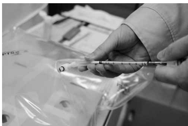
図20 ガス検知管でガスバッグ内の酢酸濃度を測定
