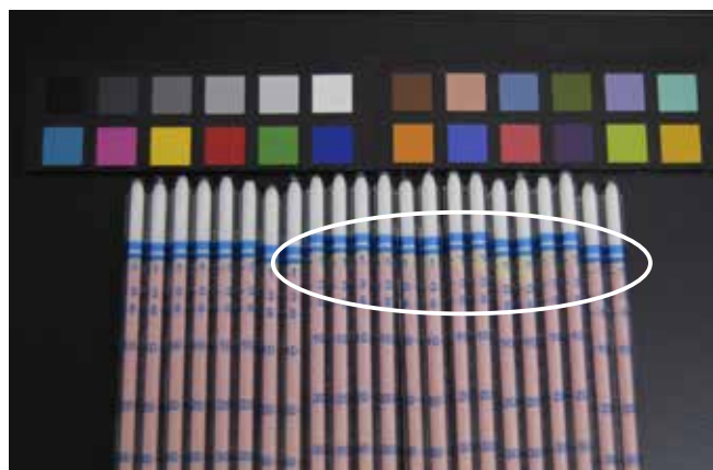
図21 ガス検知管でガスバッグ内の酢酸濃度を測定 (丸印の中が変色部分)
